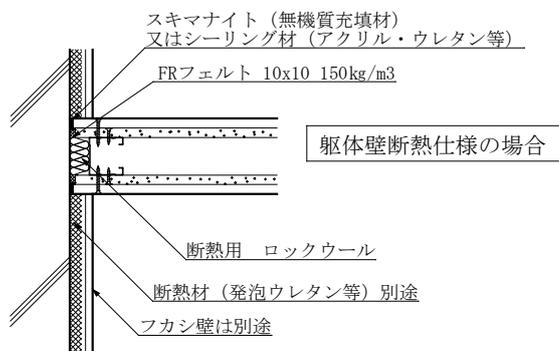
※. 断熱用ロックウールの必要充填厚さについては躯体の断熱仕様の種類により異なります。
