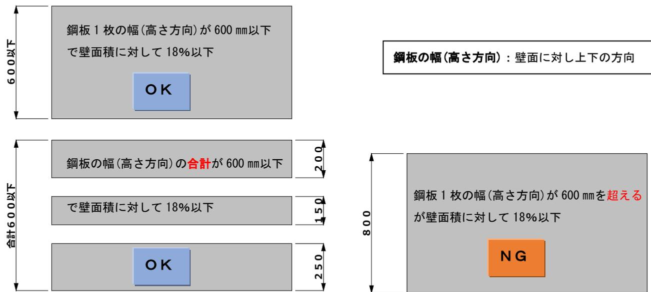
※ 鋼板の寸法が 600 mm 以下でも鋼板面積が壁面積に対して 18% を超える場合はいずれも不可になります。
