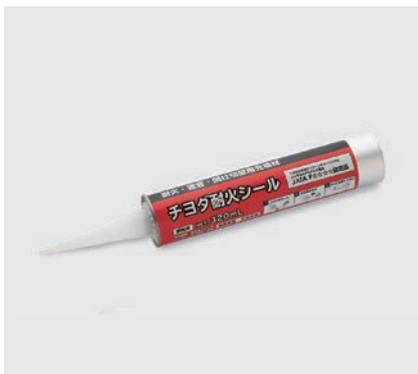
熱が加わると膨張する機能を持ち、せっこうボードの収縮・変形による目地開きを塞ぐ事で熱の侵入を抑制します。
