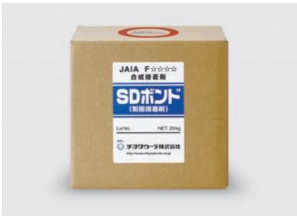
固体伝搬音対策のため、せっこうボードを重ね張りするときに使用する弾性接着剤です。壁に当たったときの音の伝わり方を軽減します。主に、当社の耐火遮音壁「ゼナジーウォール 21C-G 固体伝搬音対策仕様」で使用します。ステープルと併用ください。1箱20kg入りです。(日本接着剤工業会 JAIA 008634)
